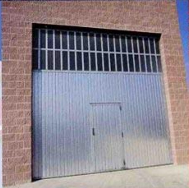
Porta corredissa Industrial lliscant amb porta de pas peatonal incorporada. Està folrada a la part inferior de xapa galvanitzada vertical i, a la part superior, té una tarja de vidre per a l'entrada de llum.
