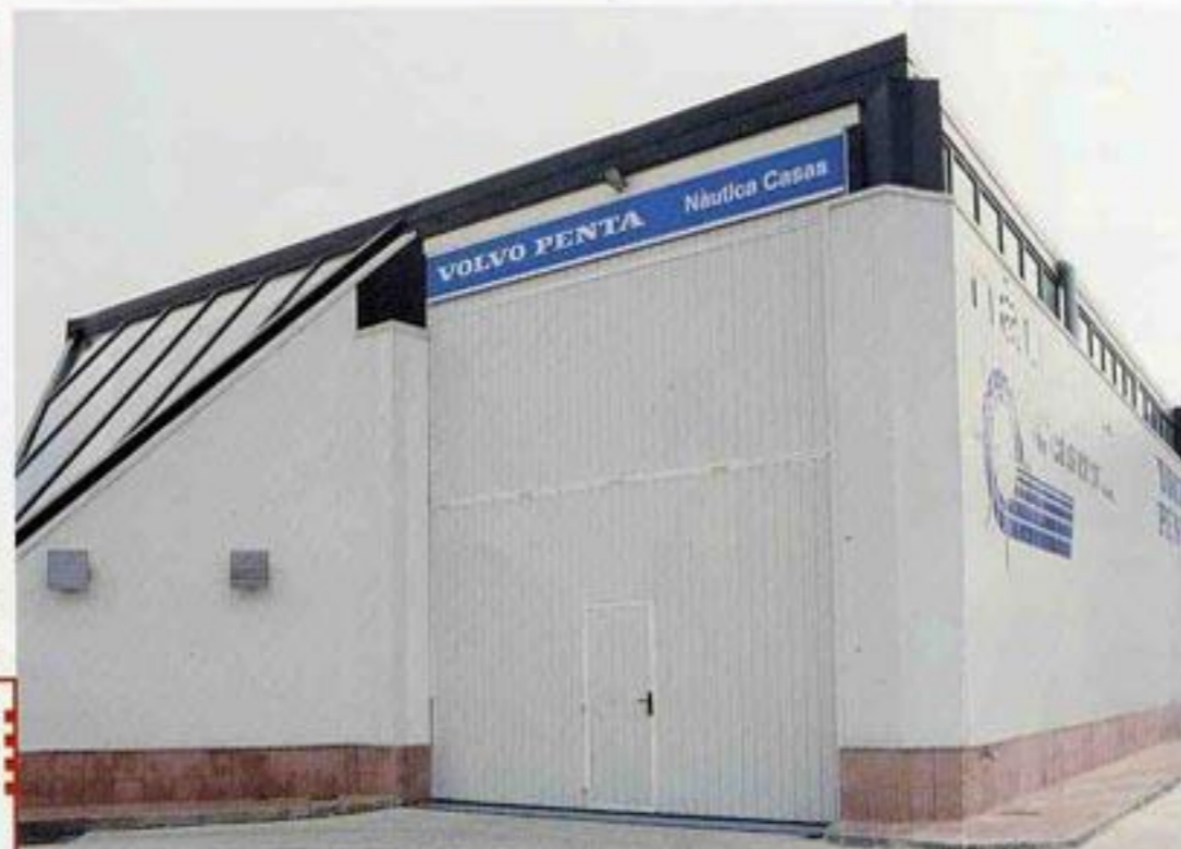
Portes basculants industrials automàtiques d'obertura a l'exterior amb portes de pas peatonal incorporades. Estan fetes de xapa i els acabats poden ser de diferents colors.
